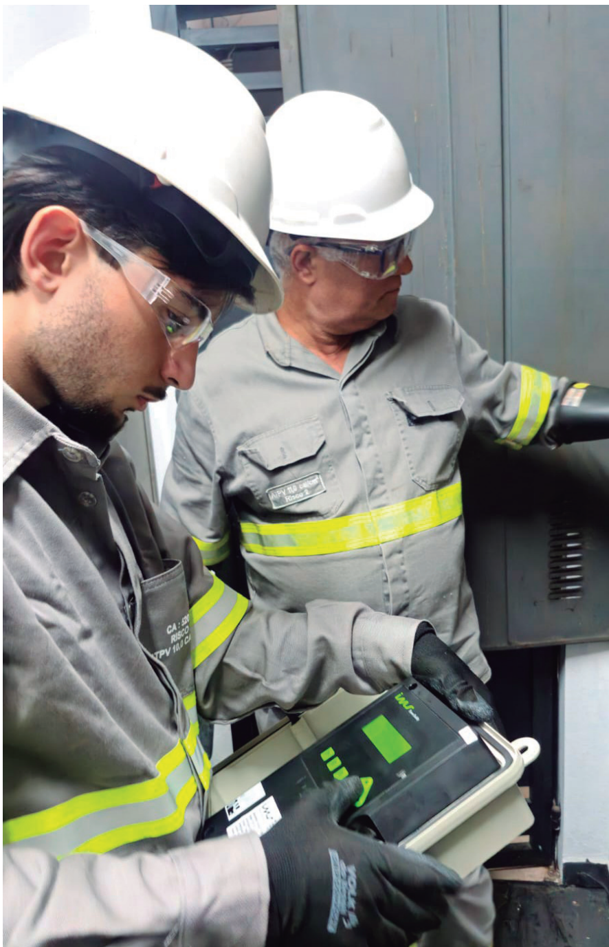
A análise da assinatura elétrica consiste em medir e interpretar o comportamento das grandezas elétricas de um equipamento durante sua operação
