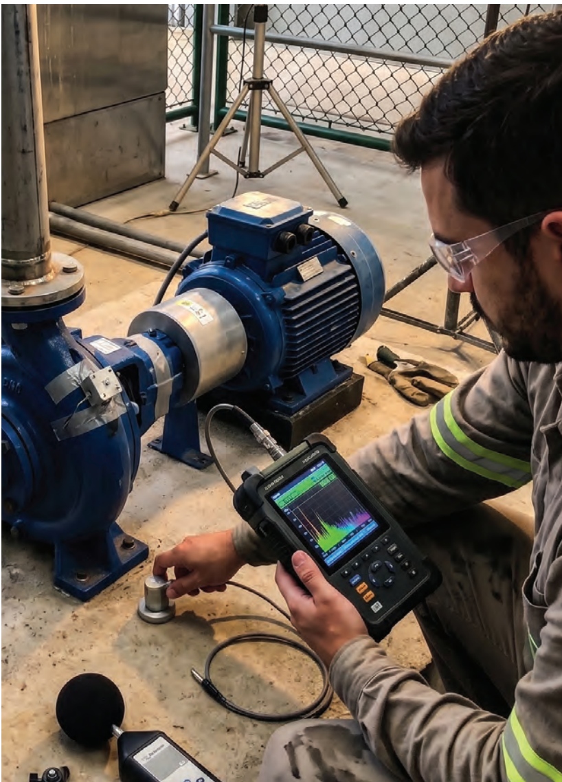
Ruídos gerados por compressores, ventiladores ou bombas costumam apresentar picos tonais bem definidos
