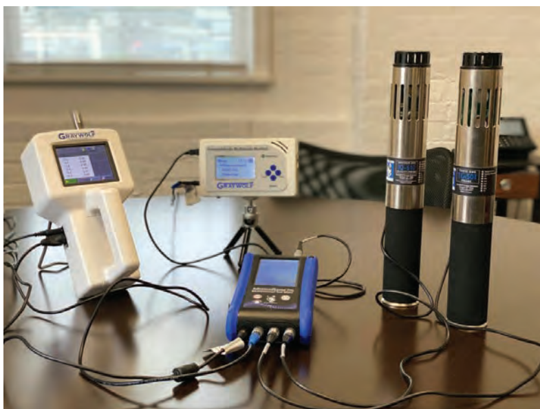
Sistemas de monitoramento de CO 2 garantem ventilação adequada, filtragem eficiente, controle de umidade e trocas de ar
