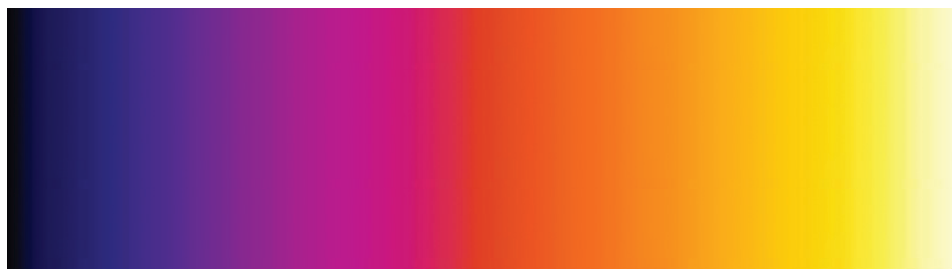
Escala de Iron. Do centro para a esquerda – temperaturas frias. Do centro para a direita – temperaturas quentes. O branco, nesse caso, é sinal de problemas graves e da necessidade de ações corretivas. Fonte: SILVEIRA, D. “Manutenção preditiva em painéis elétricos com a utilização da termografia”.
