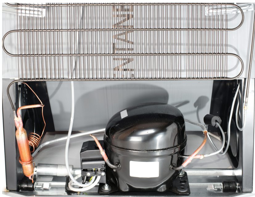
Componente essencial dos sistemas de refrigeração e ar condicionado, compressor responde por mais da metade do consumo de energia de um sistema do gênero
