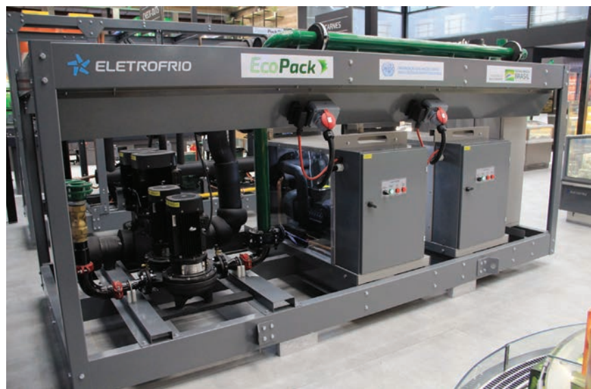
Rack com R-290 desenvolvido pela Eletrofrío em parceria com o Ministério do Meio Ambiente e agência da ONU, um dos destaques do setor com enfoque ambiental
