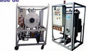
Equipamentos de Termovacuio P/tratamento óleos isolantes e lubrificantes hidráulicos
