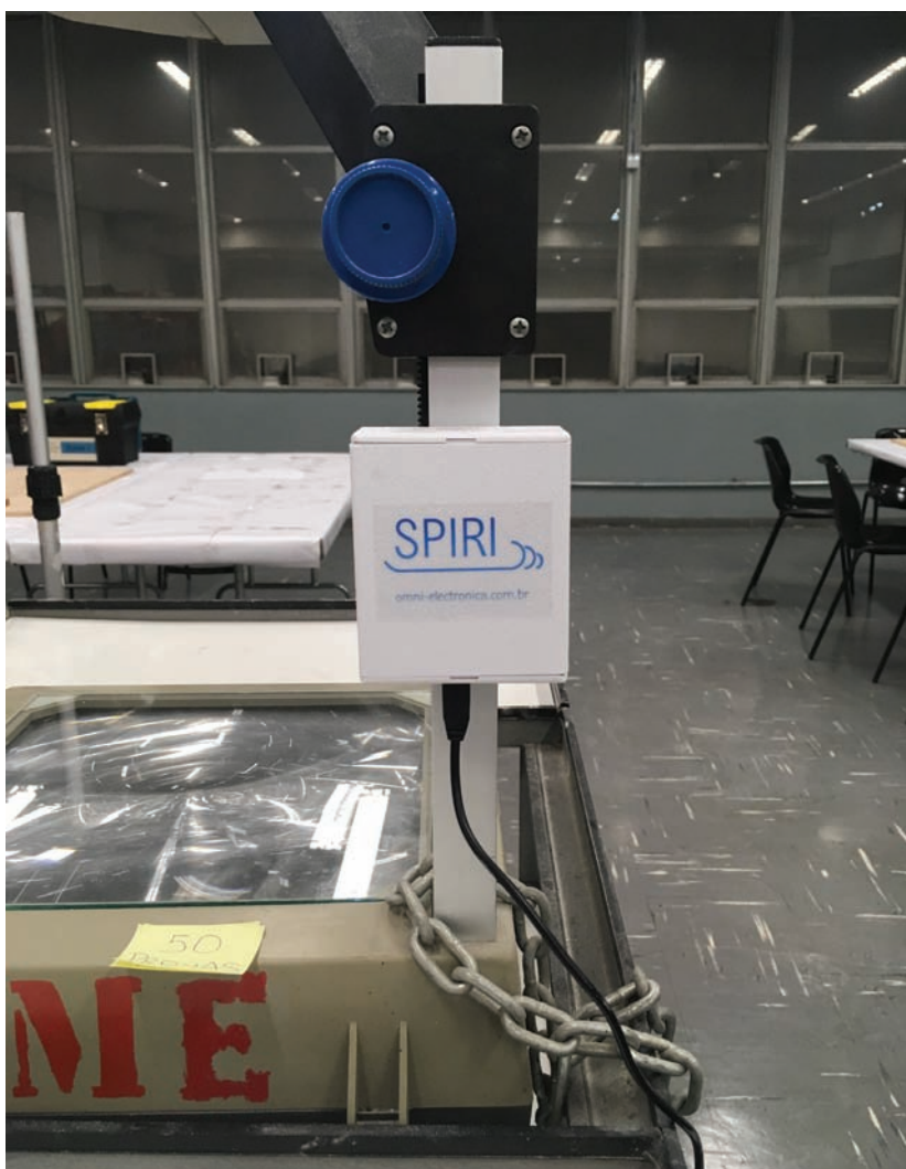
Pequeno sensor desenvolvido por startup para medir CO 2 , particulados e outros contaminantes presentes no ar
