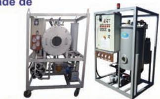
Equipamentos de Termovacu P/tratamento óleos isolantes e lubrificantes hidráulicos
