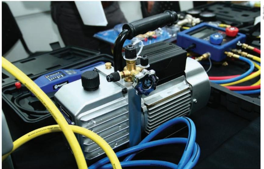
*Bomba de vácuo fabricada pela Mastercool*
