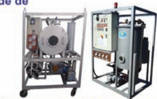
Equipamentos de Termovacu P/tratamento óleos isolantes e lubrificantes hidráulicos
